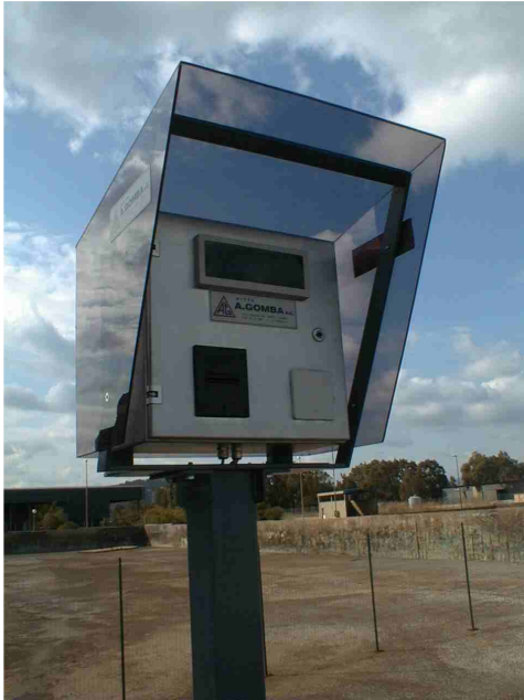
Vista del Dispositivo della parte frontale con evidenza del lettore transponder per la lettura dei Badge e vista della
